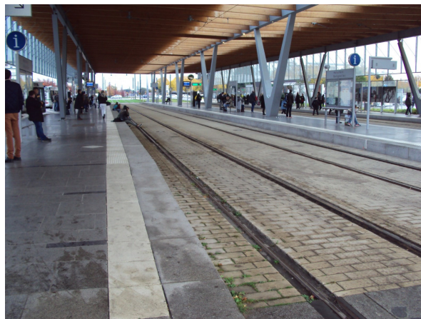
Illustration 8. Bande contrastée sur les quais
