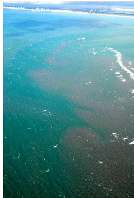
Figure 18 : Panache turbide généré par les dragages de la Flèche de l'Espiguette pour le rechargement du Golfe d'Aigues-Mortes
