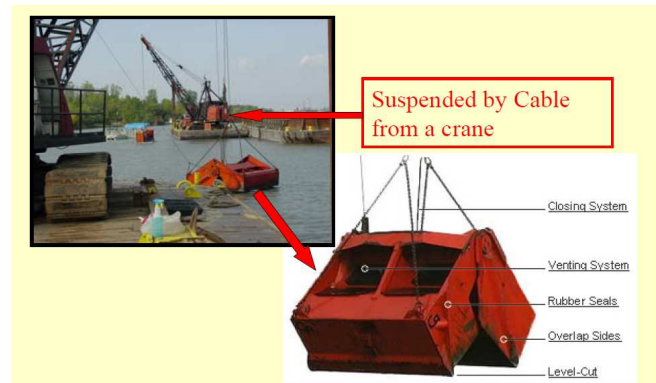
Figure 11 : Illustration de l'évolution environnementale d'une benne preneuse
