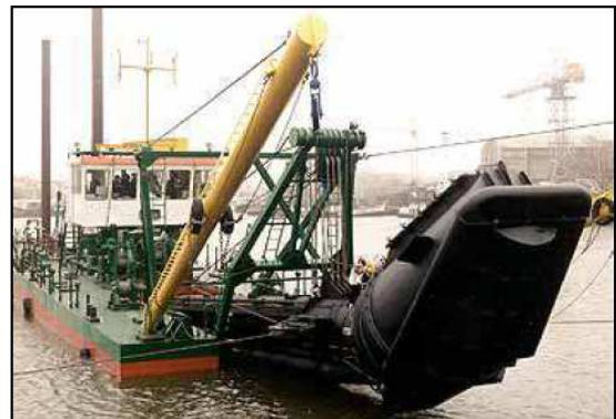
Figure 13 : Illustrations d'une tête d'aspiration à cylindre rotatif et outil d'encapsulation d'un disque désagrégateur
