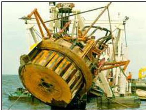
Figure 13 : Illustrations d'une tête d'aspiration à cylindre rotatif et outil d'encapsulation d'un disque désagrégateur
