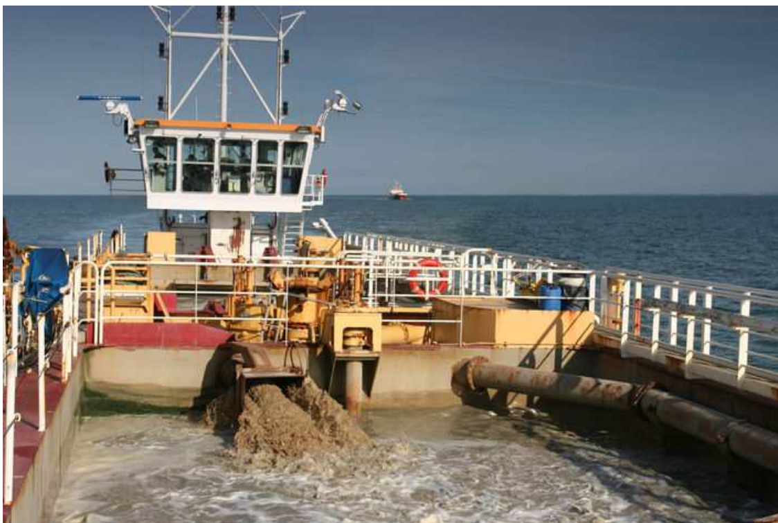
Figure 3 : Refoulement de matériaux dragués dans le puits d'une drague (Source : Ifremer)
