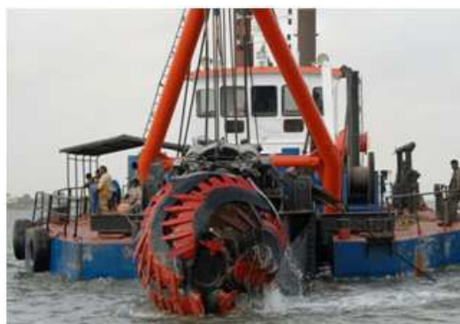
Figure 4 : Drague hydraulique à tête désagrégatrice
