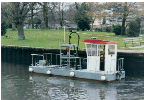
Figure 2-1 : La drague à agitation « Neptune » (source : terra et aqua), et la drague « Side Cast Merrit » (US Army)
