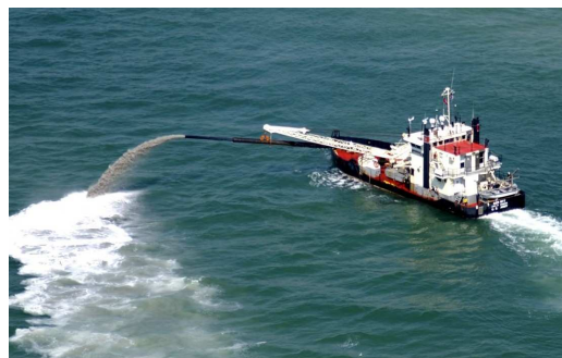
Figure 2-1 : La drague à agitation « Neptune » (source : terra et aqua), et la drague « Side Cast Merrit » (US Army)
