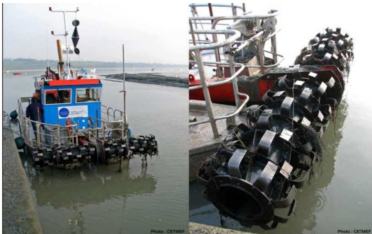
Figure 2-4 : Rotodévaseur « Le Rochevilaine » utilisé dans l'estuaire de la Vilaine (source : CETMEF)
