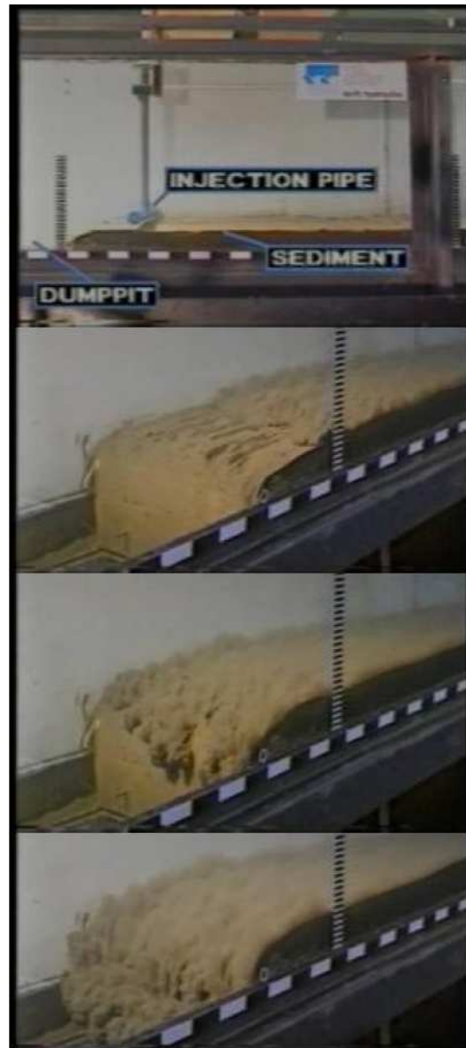
Figure 5-1 : Modélisation physique d'un courant de densité (BORST 1994)
