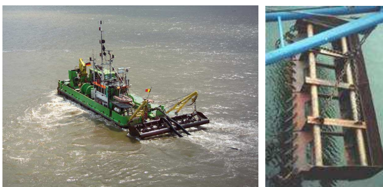
Figure 2-3 : La drague à charrue Alligator (DEME) et détail d'une niveleuse (source Anthony Bates Partnership)
