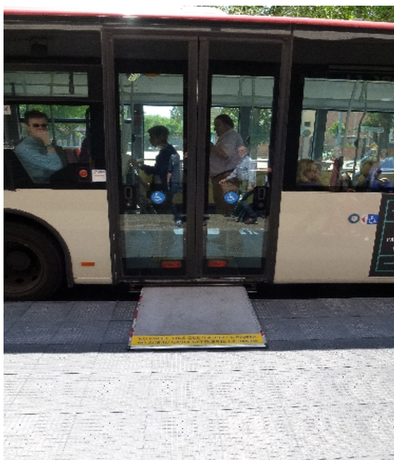
Déploiement de la rampe d'accès
