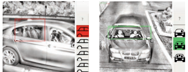
Vues du capteur Xerox mesurant le covoiturage avec prise d'images de côté et de face (pare-brise) (© Cerema, XEROX)
