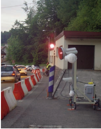
Acquisition d'images par les caméras infrarouge lors de la période de pointe du matin (4h30-8h) (© Cerema)
