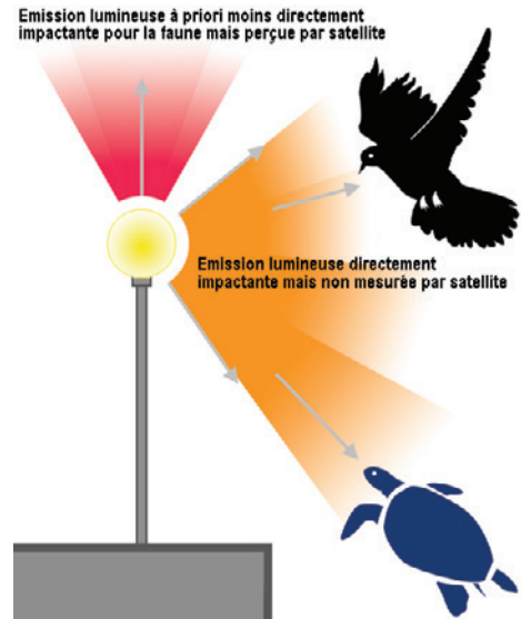
FLUX LUMINEUX ZÉNITHAUX ET AUTOUR DE L'HORIZONTALE ÉMIS PAR UN LAMPADAIRE TYPE « BOULE »
