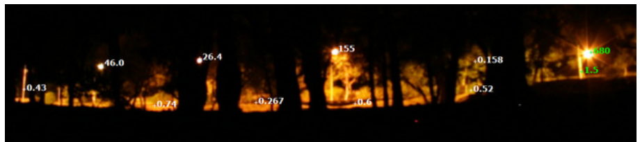
Carte de luminance illustrant les quantités de lumière perçues depuis la plage à hauteur de tortue marine (valeurs en \text{cd}/\text{m}^2 )
