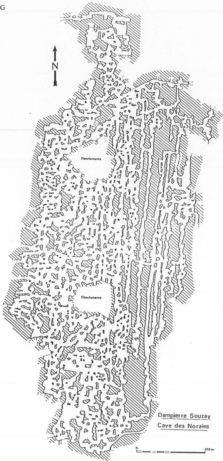
Fig. 3 - Ancienne carrière souterraine dans le tuffeau - (d'après plan de la S.C.A. Champignonnières de DAMPIERRE)
