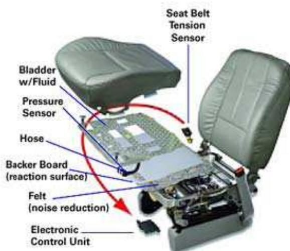
Figure 1 : Système de détection passive du poids d'un occupant d'un véhicule.
