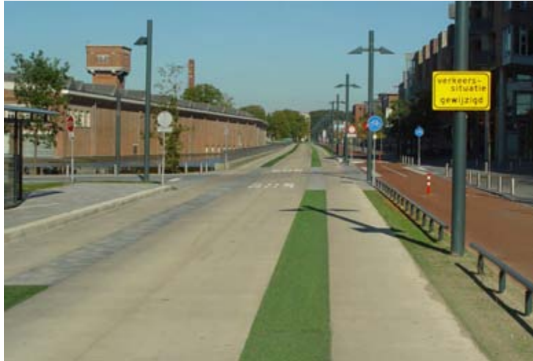
Twente: feux d'avertissement au sol à un carrefour, qui clignotent lorsqu'un bus arrive. Le panneau jaune indique « gestion du trafic modifié »
