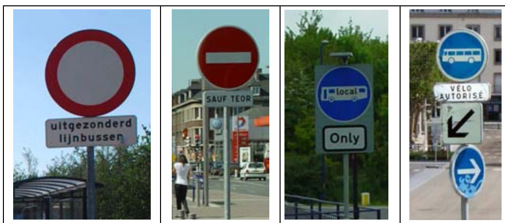
Différent types de panneau signalant la voie dédiée: Twente, TEOR, Fastrack, Triskel; Un marquage sur chaussée en entrée ou un bon contraste visuel sont toujours très efficaces.
