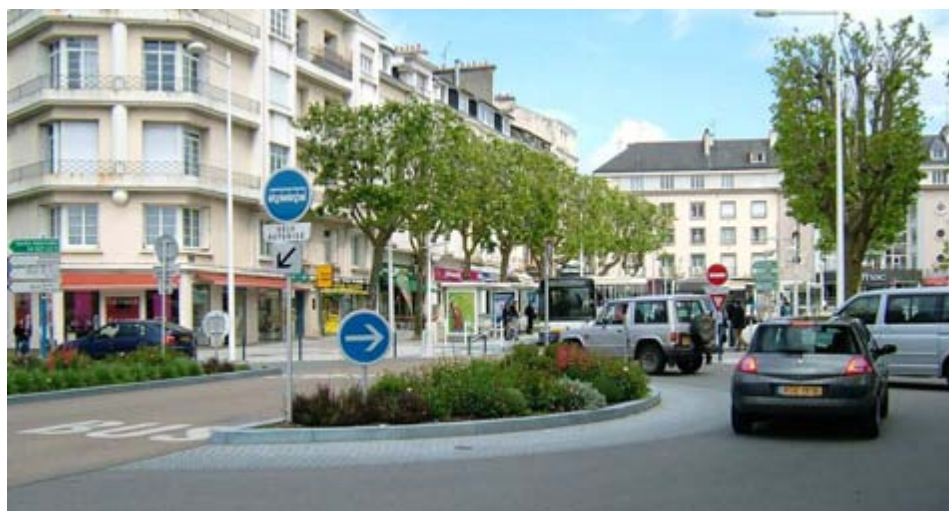
Lorient : présence de nombreux giratoires traversés dans la zone 30 centrale ; ils sont dépourvus de feux tricolores en raison d'une circulation irrégulière des bus (regroupant jusqu'à 8 lignes).
