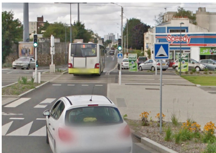
Photo 17 : signaux R11v en barrage sur une traversée de branche de giratoire
