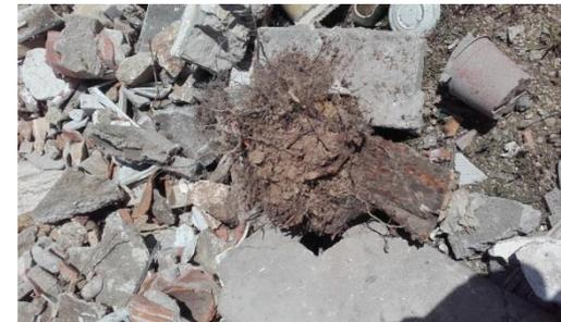
**Mélange hétérogène de briques, bétons, ardoises , terres, exogènes liés ou non**
