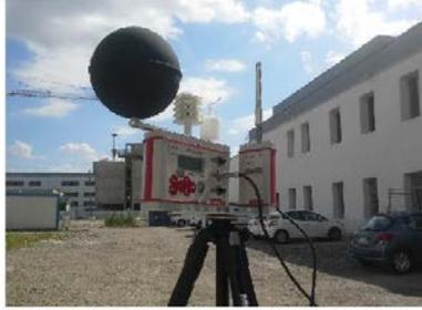
Station de météo mobile mesurant température moyenne radiante, température d'air, hygrométrie et vitesse d'air
