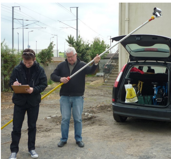
Illustration 6: Mise en place de la caméra sur la fourche télescopique
