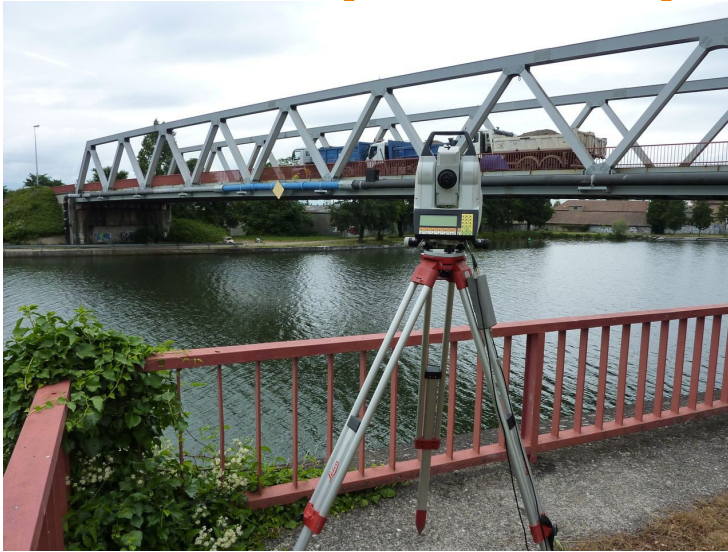
Mesures de flèches au tachéomètre
