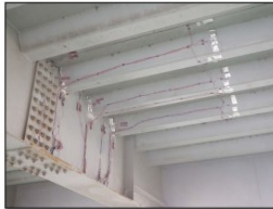
Cible tachéomètre Thermocouple (ThC) Jauge unidirectionnelle (JW)
