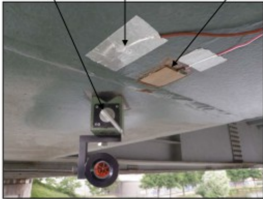
Cible tachéomètre Thermocouple (ThC) Jauge unidirectionnelle (JW)
