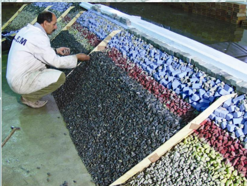
Modélisation à l'échelle 1/60 d'une portion de digue en bassin à houles
