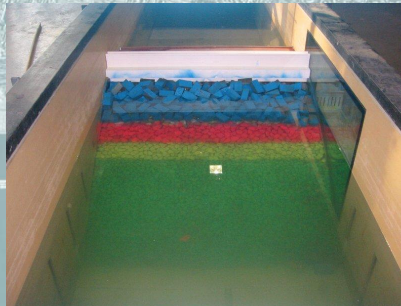
Test en canal à houle avant et après tempête cinquantennale
