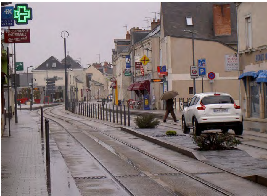
Site 1 : en centre-ville, et au niveau de la station Saint-Gilles, le séparateur est mis à niveau et remplacé par des potelets.
