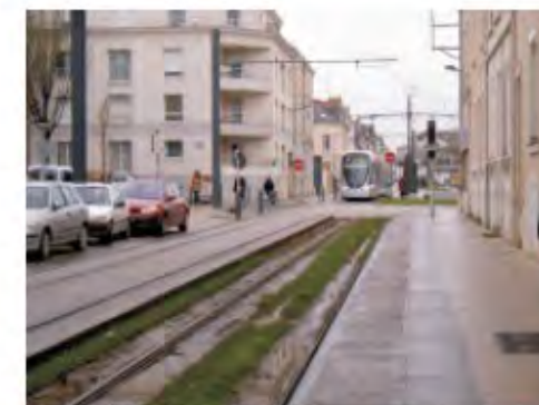
photo 20 : passage véhicule sur site propre, l'espace entre le rail droit et le trottoir est destiné aux cyclistes
