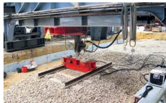
préalablement détachée ou non du rail. Les paramètres mesurés lors de la sollicitation dynamique devront permettre de calculer la rigidité de la couche du ballast. Grâce à cet outil, les gestionnaires pourront diagnostiquer, optimiser et contrôler la maintenance des voies ferrées. Les essais se poursuivent en 2015.
