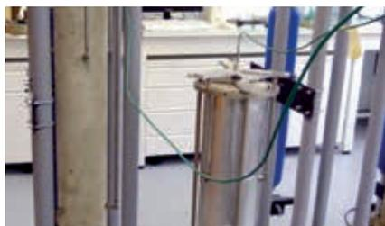
Le Cerema a réalisé, dans son laboratoire éco-matériaux de Sourdon, des essais à échelle réelle de retrait endogène sur des bétons destinés à servir de structure pour les radiers et les voiles. Ces derniers ont permis de suivre le comportement du béton dans le temps, en mesurant en continu le retrait du matériau par auto-dessiccation, sur des échantillons
