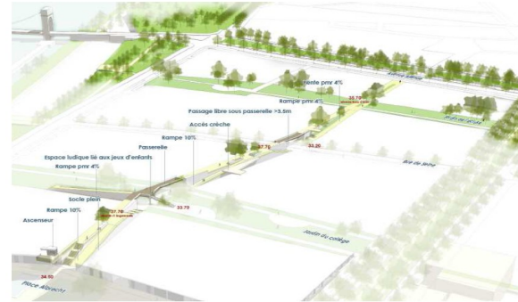
Promenades hautes pour accéder aux immeubles en cas de crue
