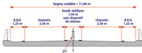
Figure 17 : exemple de profil en travers minimal d'un ouvrage d'art non courant
