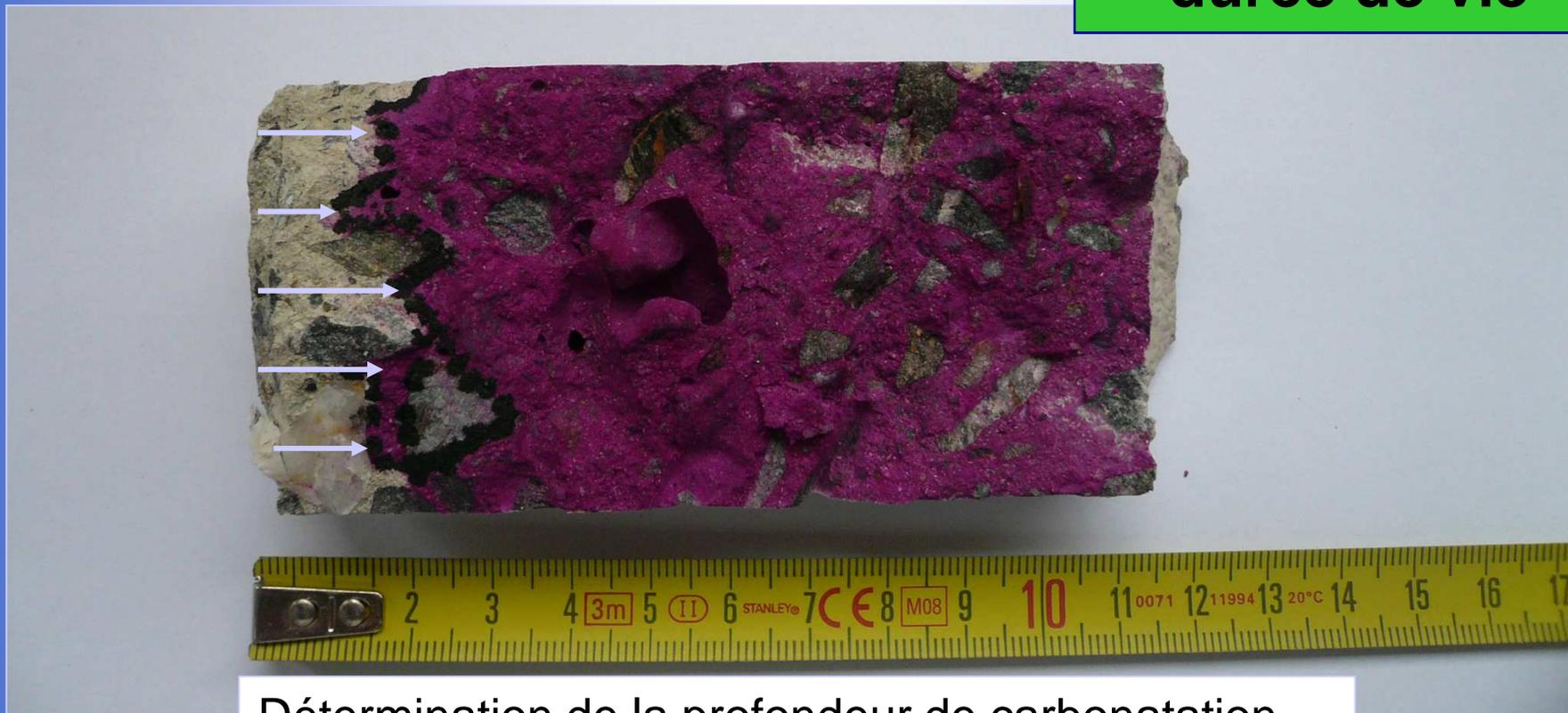
Détermination de la profondeur de carbonatation ( $X_c$ ) par méthode colorimétrique (phénol-phtaléine)
