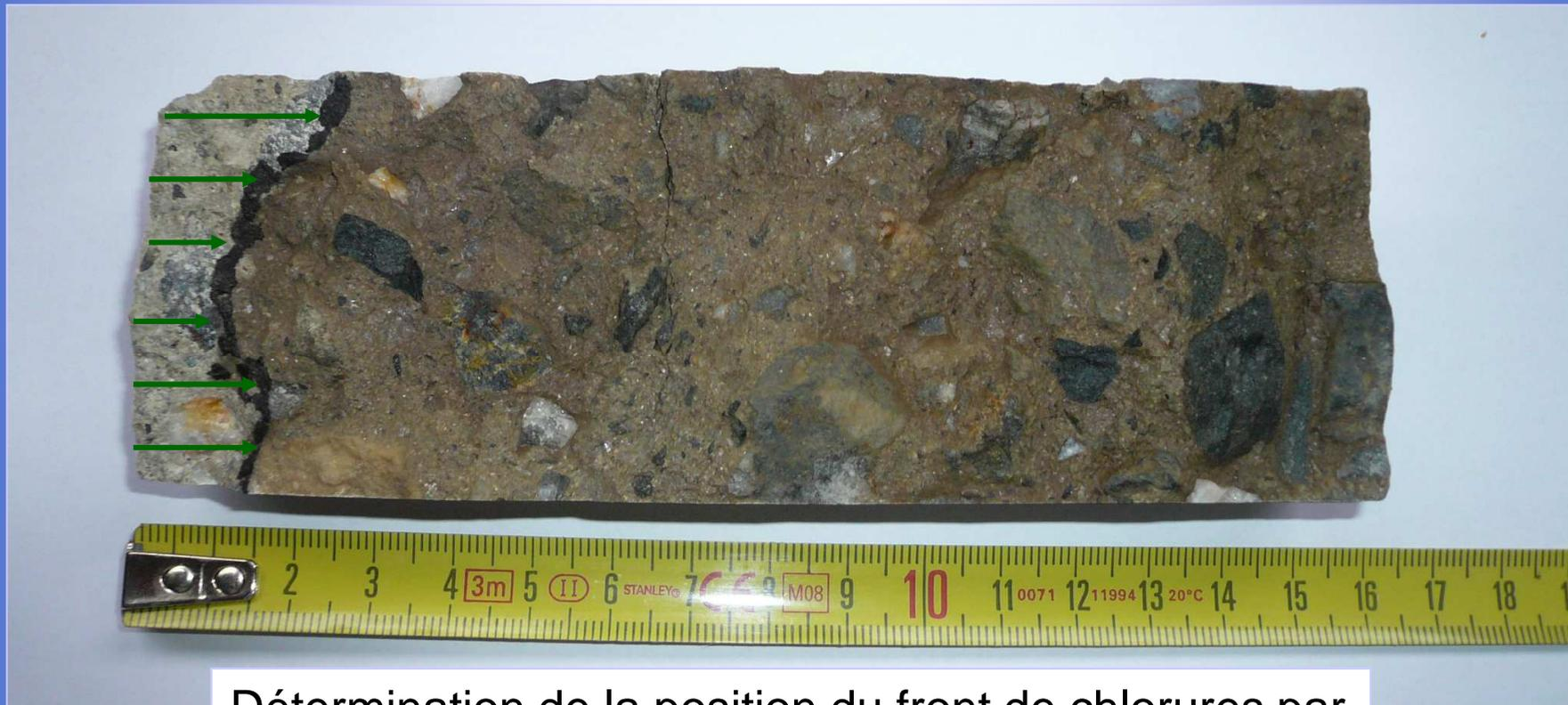
Détermination de la position du front de chlorures par
