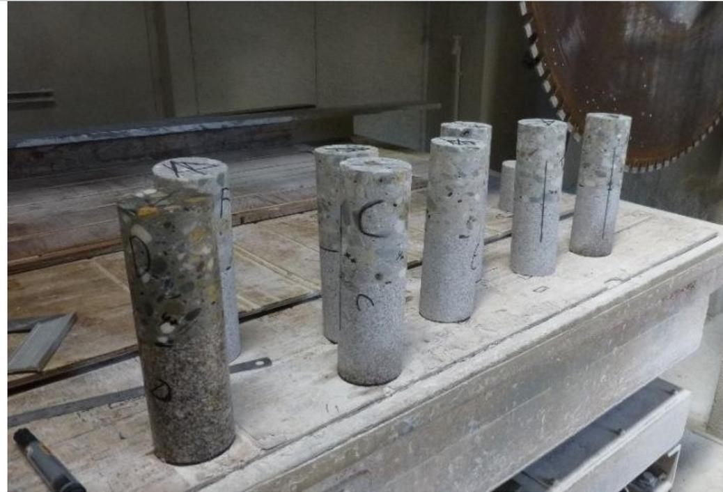
Photographie des huit carottes béton – roche après surfacage des extrémités (NF XP P94-424) (plan moyen parallèle et à mi-distance des extrémités)
