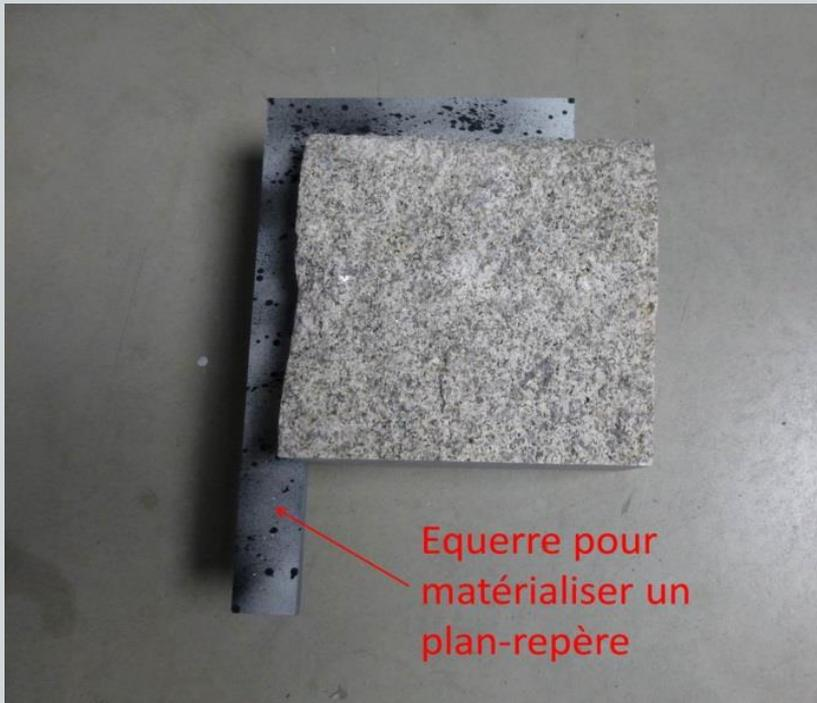
Découpage dans un grand bloc de roche de neuf échantillons de surface naturelle 180 x 180 mm
