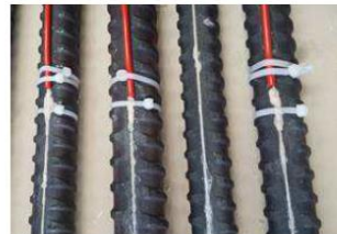
(b) Fixation et protection de la F.O en tête de la partie scellée
