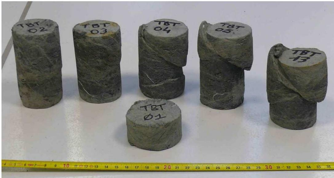
Essai triaxial à haute pression, éprouvettes après essai (diamètre 50 mm)
