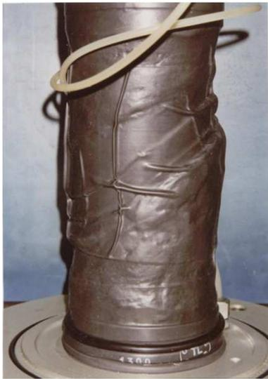
Eprouvette triaxiale (diamètre 100 mm)
