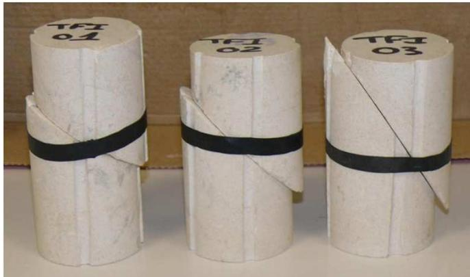
Eprouvettes triaxiales prédécoupées, diamètres 50 mm
