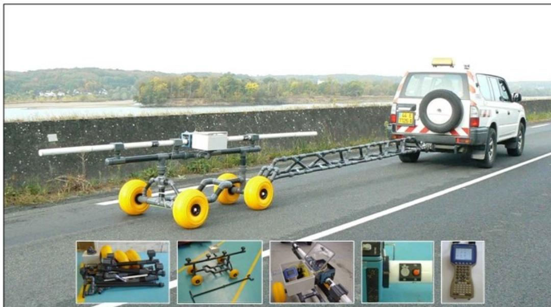
**Ce chariot léger et démontable permet l'utilisation d'un conductivimètre EM31 sans perturbation des mesures électromagnétiques.**
