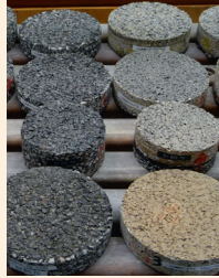
-Photo 1- Carottes de revêtements du projet.
