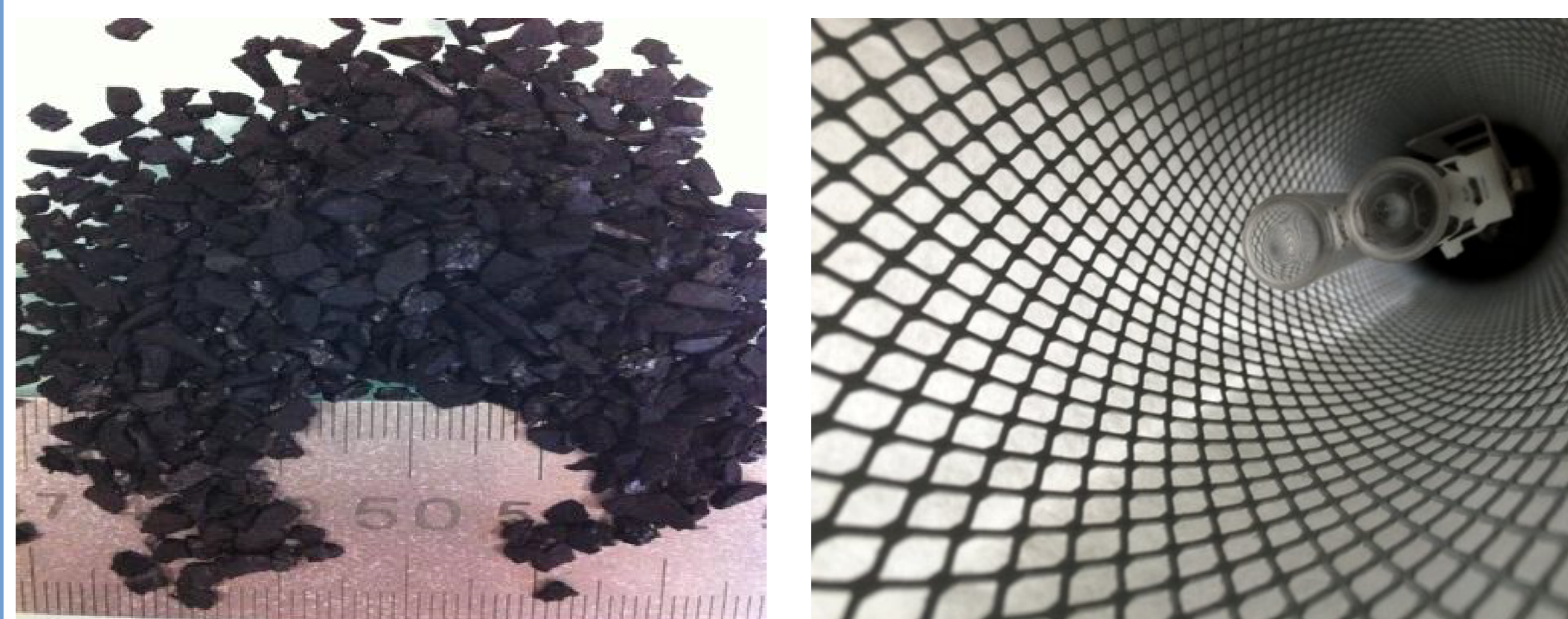
Charbon actif et réacteur photocatalytique
