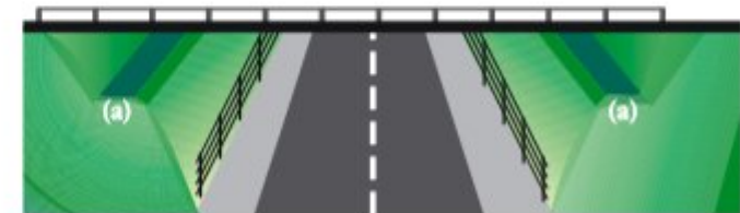
Figure 97 - Clôtures raccordées aux OA de manière à ce que les animaux ne trouvent aucune possibilité de se faufiler et soient contraints d'utiliser les ouvrages - (a) = faux plats.
