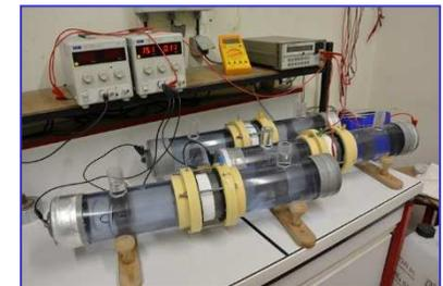
**Essai de perméabilité au gaz sur béton durcis : XP P18-463**
