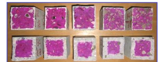
**Essai d'absorption d'eau : NF EN 13369, Annexe G**
