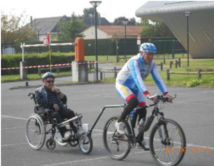
2 Modules Tout Chemins (MTC) pouvant être utilisés seuls (balades pédestres) ou reliés à un vélo
