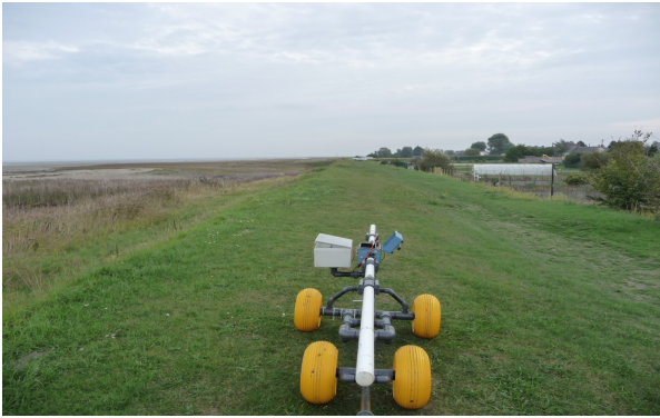
FIGURE 4: EM31 SUR SON CHARIOT EN CRÊTE D'OUVRAGE
