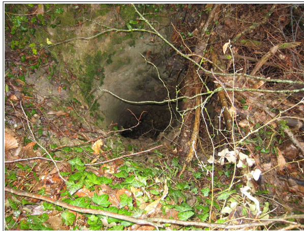
Illustration 1.7 : Puits d'accès à une extraction souterraine, Thoiré-sur-Dinan (72), 2009
