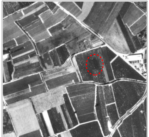
Illustration 2.29 : Dépression présentant un contraste colorimétrique avec son encaissant ; nota : la dépression de l'illustration 2.28 n'est pas visible [cliché IGN 1979]
