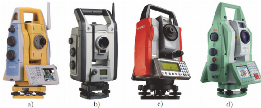
IATS existantes : a) Topcon IS-3 ; b) Trimble S9 ; c) Pentax Visio ; d) Leica Nova de Wagner et al. (2016)
