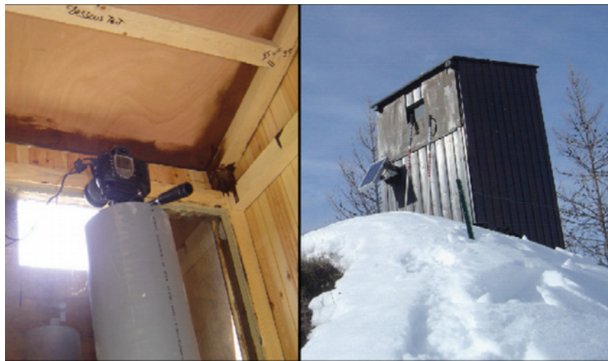
Appareil photographique à demeure en face du glissement de Super Sauze (Traveletti et al., 2012)
