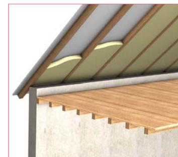
Isolant en sous face de la couverture
