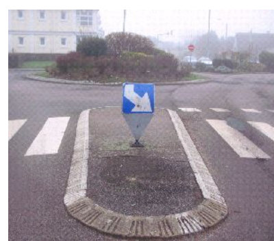
Supports de signalisation de police souples (autorisation nécessaire) Sources: Transport of London, CETE NC.
