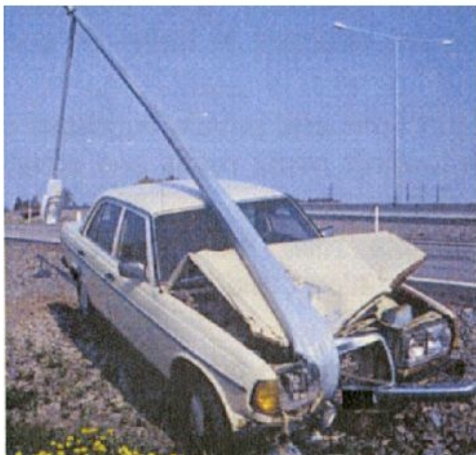
Support de candélabre à absorption d'énergie
