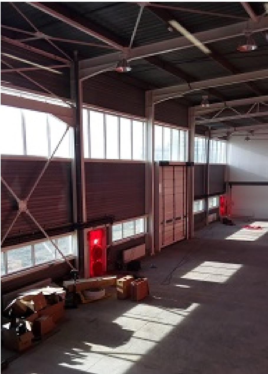
La mesure du bâtiment à réception a été réalisée successivement suivant cinq protocoles possibles, puis les résultats de mesure ont été comparés sur les critères suivants :
