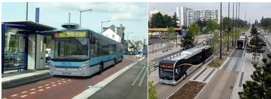
Des bus à haut niveau de service avec des plateformes dédiées et différenciées du reste de la voirie : à gauche, BHNS TEOR à Rouen et à droite, BHNS Busway à Nantes (Photo : Cerema)
