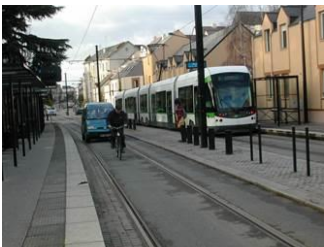
Exemple de plateforme tramway, ouverte aux autres modes (voitures et vélos) (Photo : Cerema)
