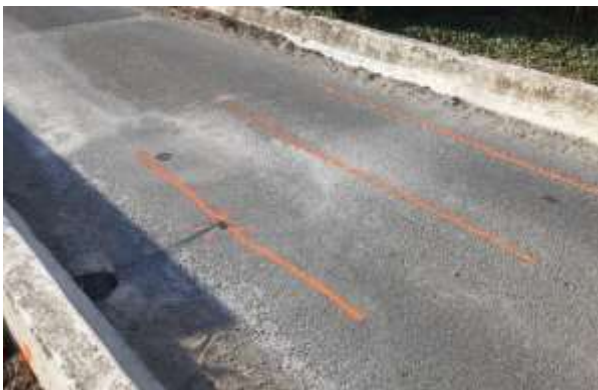
Figure 3 : Chaussée instrumentée par un géophone
