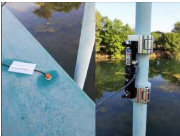
Figure 1 : Instrumentation Smart Pontem, accéléromètre (gauche) et dynamomètre (droite)
