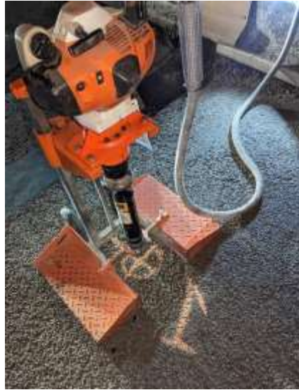
Figure 4 : Carotteuse pour réalisation de prélèvement
