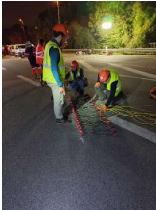
Figure 5 : Déploiement de la chaîne de géophone (sismique active)
