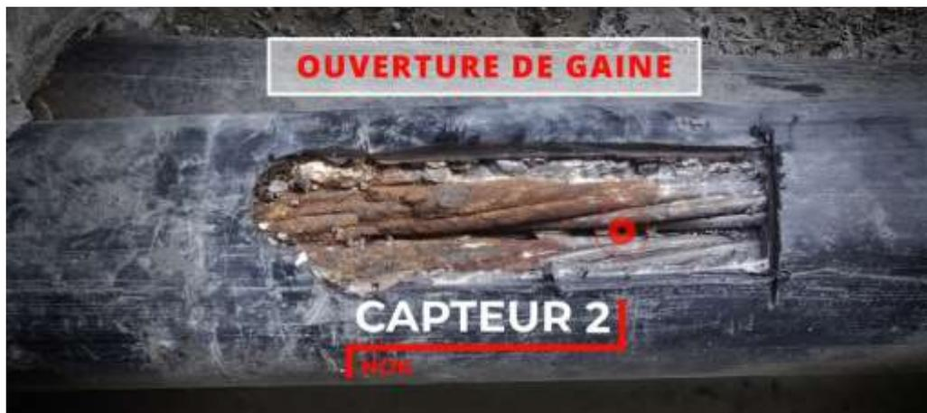
**Axe B : Capteurs de corrosion intégrés aux ancrages**
