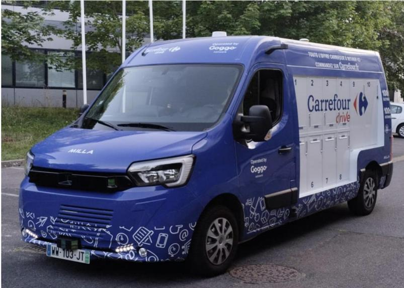
**La navette :** MILLA Delivery avec 23 casiers connectés en 2 tailles. Équipée de 6 lidars et 4 caméras pour la conduite autonome.
