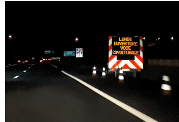
Message sur PMV / PIA et remorques PMV
