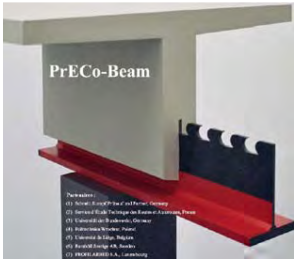
Cas 1 : demi-profilé et hauteur constante. Découpe PRÉCO pour le bâtiment
