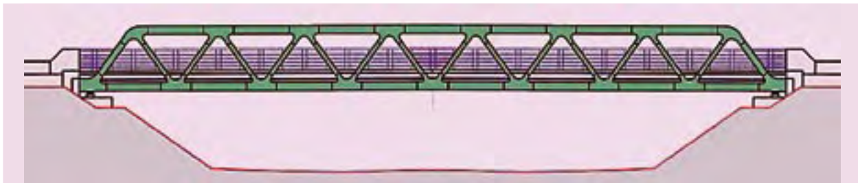
Figure 1 : option en treillis, projetée initialement
