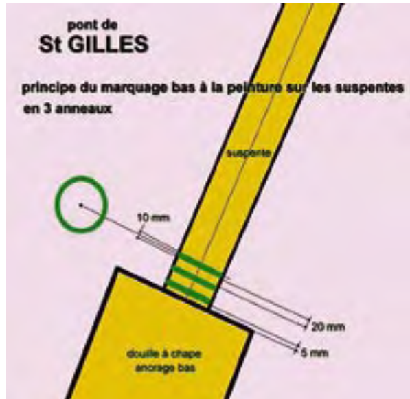
Figure 5 : câbles clos : marquages à la peinture au pied des suspentes
