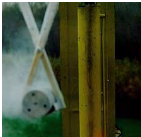
Photo 5 : axe posé à basse température Source : Jacques Berthelémy (Sétra)
