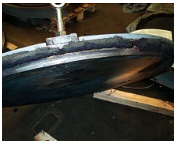
Photo 2 : un piston et état du joint Compriband®.
