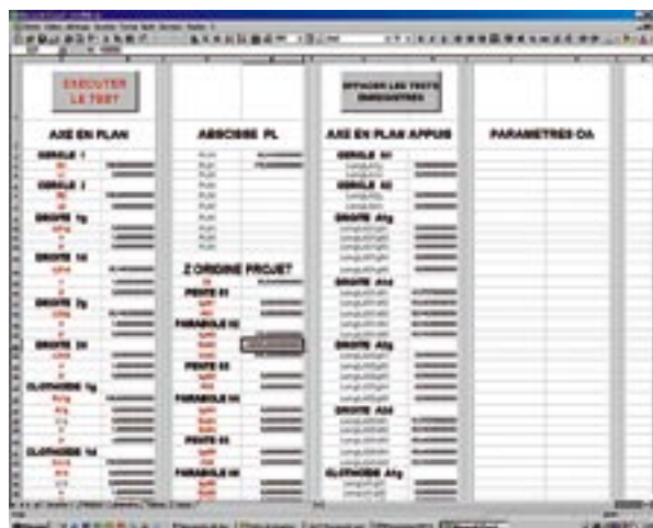
Figure 8 : fichier avec macro Excel servant au calcul des points du fil rouge et déterminant la géométrie du rail de lissage
