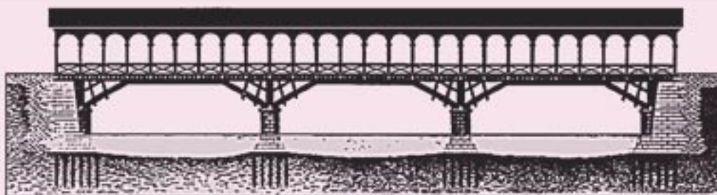
Figure 5 : projet de Pont des Arts dessiné d'après les idées d'André Palladio. À noter les fûts de pile en maçonnerie, fondés sur pieux de bois.
