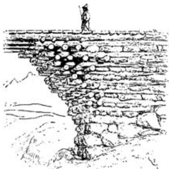
Figure 3 : culée en cap-marteau, d'après un dessin de Viollet-le-Duc.
