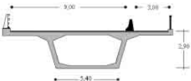
Coupe schématique de la solution monocaïsson
