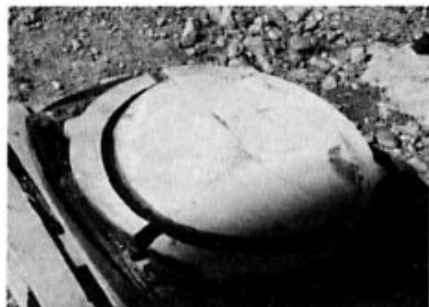
Rupture de la virole en 3 morceaux
