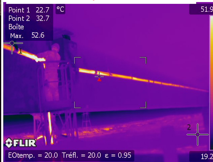
Contrôle injection à la cire
