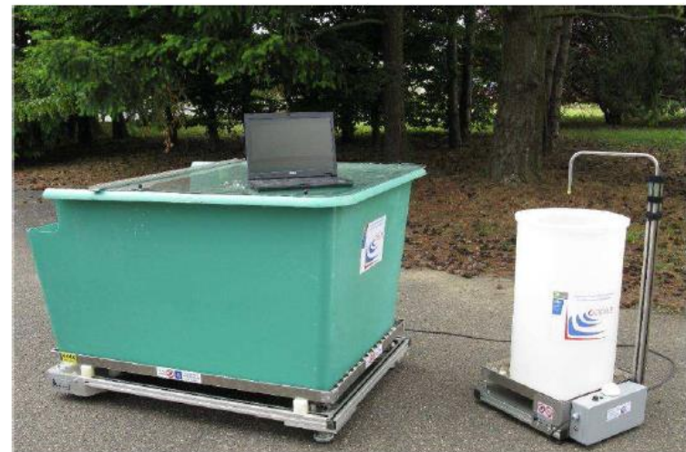
Système de contrôle statique ODEMIE du Cerema
